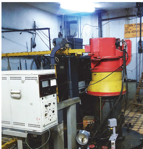
Рис.3. Третий клистронный пост после восстановления.
