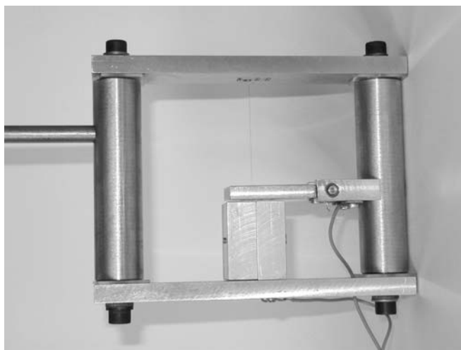
Рис.7. Фотография SVC_БА, установленного на выходе пучка из инжектора ереванского синхротрона.
