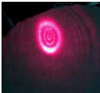
Рис.3. Изображение He-Ne лазера на экране при угле между поляризацией лазера и направлением директора у передней стенки ячейки  $45^\circ$ .
