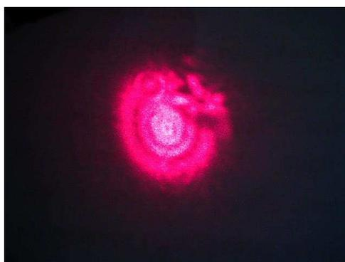
Рис.4. Изображение He-Ne лазера на экране при угле между поляризацией лазера и направлением директора у передней стенки ячейки  $90^\circ$ .
