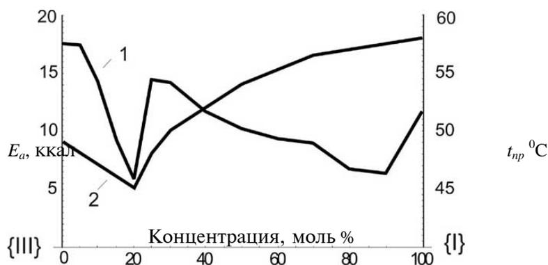
Рис.3. Концентрационная зависимость энергии активации  $E_a$  (1) и температуры просветления  $t_{пр}$  (2) для {III}/{I} ЖК системы.
