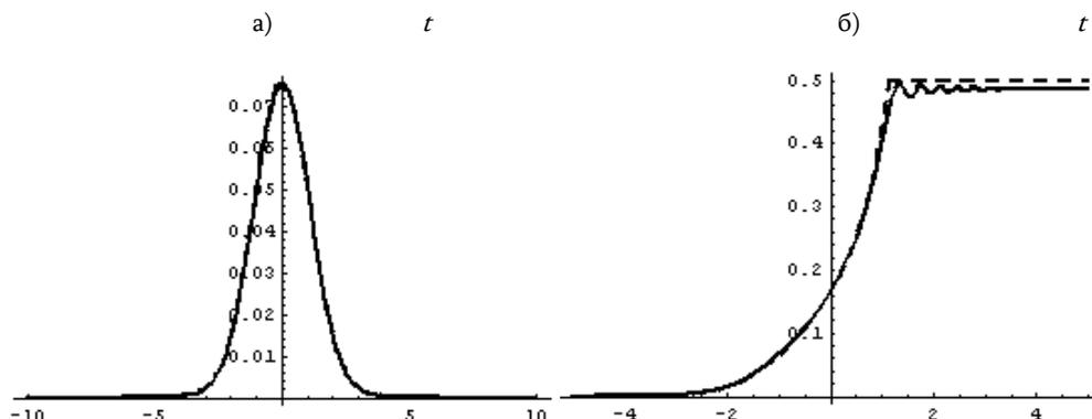
Рис.1. Вероятность молекулярного состояния как функция времени. Сплошная линия – численное решение, пунктирная линия – предельное решение (10). а) Модель Розена–Зинера.  $U_0 = 20$ ,  $\delta_1 = 10$ . б) Первая модель Демкова–Кунике.  $U_0 = 20$ ,  $\delta_1 = 10$ .
