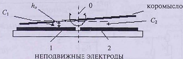
Рис.1. 1 и 2 – неподвижные электроды емкостей C_1 и C_2 , сформированные на фольгированном стеклотекстолите; h_0 – задаваемый слюдяной прокладкой зазор между плоскостью коромысла-электрода и электродами 1,2; O – ось качания коромысла.
