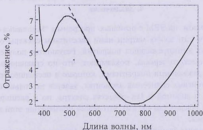
Рис.2. Спектр отражения диэлектрического зеркала при следующих параметрах слоев: n_1=1.38 ; n_2=2.3 ; n_3=1.38 ; n_4=2.3 ; d_1=10 нм; d_2=40 нм; d_3=98 нм; d_4=10 нм. Штриховая линия показывает прямой ход кривой при отсутствии минимума.
