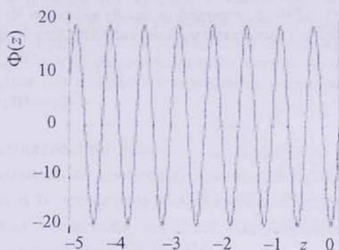
Рис.2. Зависимость безразмерного потенциала  $\Phi(z)$  заряженной частицы ( $\lambda_j = 10$ ) от  $z/\lambda_{De}$  при  $a = 10$ .
