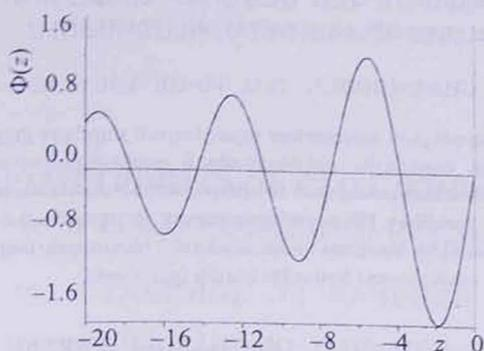
Рис.1. Зависимость безразмерного потенциала  $\Phi(z) = (q/\lambda_{De})^{-1}\varphi(z)$  заряженной частицы ( $\lambda_j = 10$ ) от  $z/\lambda_{De}$  при  $a = 1$ .
