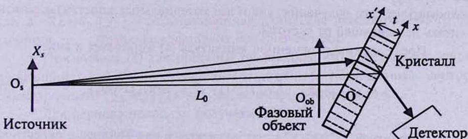
Рис.1. Схема дифракции излучения.
