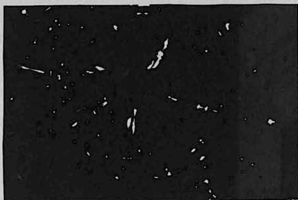
Рис.2. Рентгенограмма, полученная от кристалла ВАС-393, при совпадении направления рентгеновского пучка с осью 3-го порядка кристалла.
