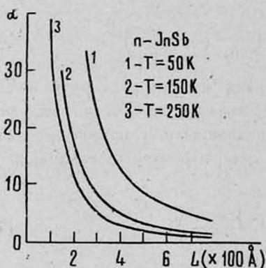
Рис. 1. Графики зависимости  $\alpha(L)$  для пленки  $n\text{-InSb}$  при различных температурах ( $N \approx 10^{18} \text{ см}^{-3}$ ).
