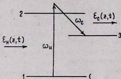
Рис. 1. Схема уровней трехуровневого атома: импульс накачки  $E_n(t, z)$  резонансен с переходом из основного состояния 1 в 2, а стоксова волна  $E_c(t, z)$  резонансна с переходом 2→3.
