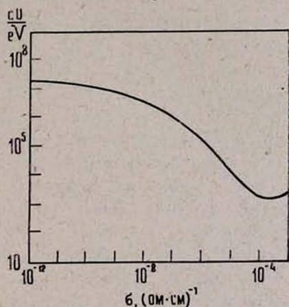
Зависимость безразмерной амплитуды от проводимости в пластине кристалла  $CdS$  толщиной 0,2 мм, колеблющейся в воздухе. Резонансная частота составляет 11 мГц.
