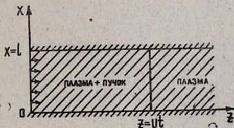
Поля, индуцируемые в слое плазмы потоком, определяются из уравнений Максвелла, которые должны быть дополнены граничными условиями
