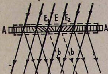
Рис. 4. Дифракция рентгеновских лучей на пластинке, подвергнутой пьезодеформации. Пластинка сжимается в направлении z . В точках E_2 и E_1 из-за увеличения наклонности отражающих плоскостей интенсивность дифрагированных лучей резко падает.
