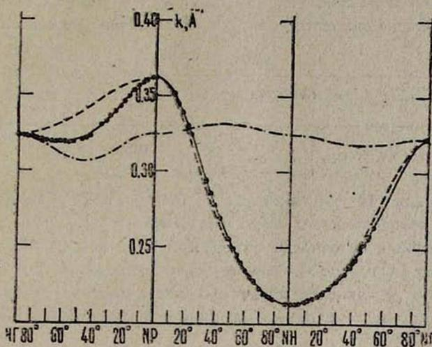
Анизотропия волновых векторов «эллипсоида» в трех взаимно перпендикулярных плоскостях симметрии: ● — экспериментальные точки; сплошная и штрих-пунктирная кривые соответствуют расчетной поверхности в первичной и преобразованной системах координат, пунктирная кривая — в первичной и преобразованной системах координат, пунктирная кривая —
