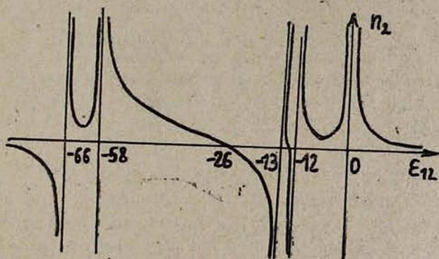
Рис. 3. Дисперсионная кривая нелинейной части показателя преломления  $n_2$  нл волны  $E_2$ . Независимо от интенсивности волн  $E_1$  и  $E_2$   $n_2$  нл имеет две точки компенсации при  $\epsilon_{12} = -12,8 \text{ см}^{-1}$  и  $\epsilon_{12} = -26 \text{ см}^{-1}$ .
