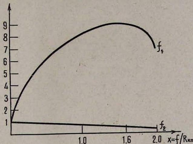
Рис. 4. Поведение безразмерных радиусов  $f_1$  и  $f_2$  пучков волн  $E_1$  и  $E_2$ . Сначала волна  $E_1$  дефокусируется, затем после  $x = 1,6$  начинает фокусироваться. График приведен для случая  $\varepsilon_{12} = -27 \text{ см}^{-1}$ .
