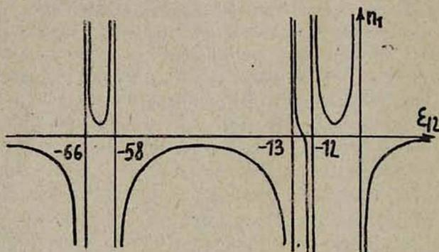
Рис. 1. Дисперсия нелинейной части показателя преломления  $n_1$ . По оси абсцисс отложена расстройка  $\varepsilon_{12}$  в  $\text{см}^{-1}$ , т. е. частота  $\omega_1$ , отсчитанная от уровня  $4P_{1/2}$ . График представлен для соотношения интенсивностей  $|E_2|^2/|E_1|^2 = 30$ .
