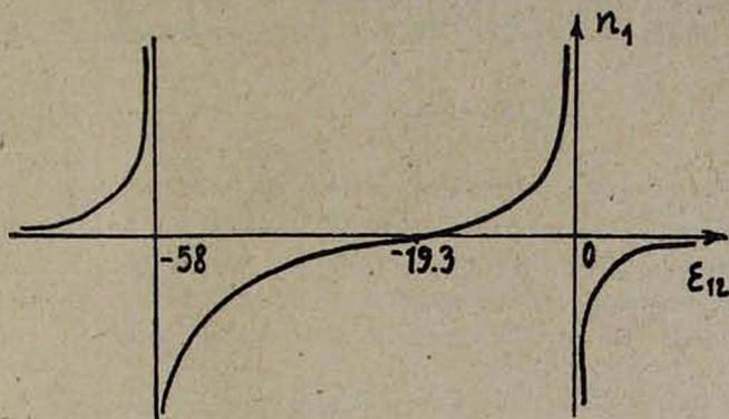
Рис. 2. График зависимости нелинейной части показателя преломления  $n_1$  в трехуровневой системе с уровнями 1, 2 и 3 при однофотонном резонансе. Положение точки компенсации не зависит от интенсивности поля  $E_1$ .
