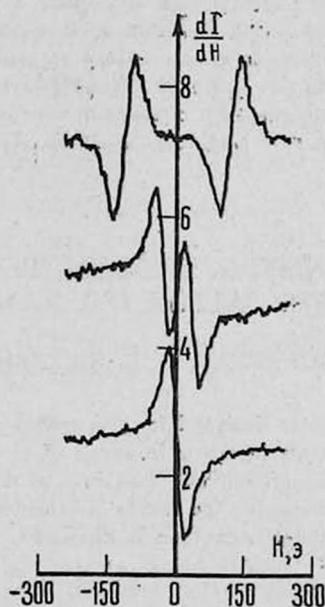
Рис. 2. Запись ЭПР-линий ионов  $Fe^{3+}$  в рутиле при различных частотах. Нижняя запись соответствует случаю совпадения энергии СВЧ-кванта с величиной начального расщепления перехода  $\pm \frac{1}{2} \rightarrow \pm \frac{3}{2}$ .
