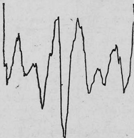
Рис. 4. Диаграмма распределения интенсивности рентгеновского рефлекса от колеблющегося по длине с частотой второй гармоники кварцевого бруска среза ХУ.
