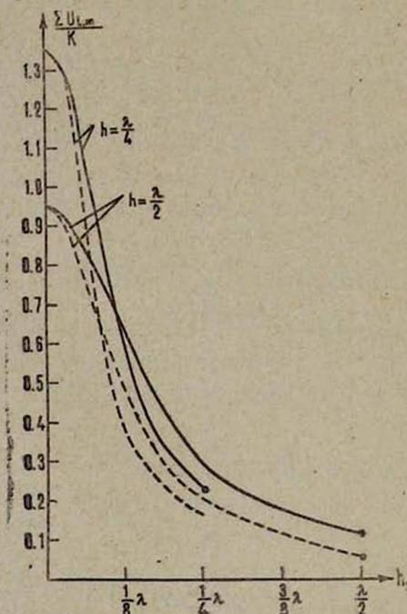
Рис. 2. Суммарные потери энергии сгустками заряженных частиц в цилиндрическом резонаторе в зависимости от длины сгустков  $h_1$  ( $h = \frac{\lambda_0}{2}, \frac{\lambda_0}{3}$  и  $\frac{\lambda_0}{4}$ ). Сплошные кривые — для случая  $\rho(x) = \frac{\pi}{2} \sin \frac{\pi v}{h_1} x$ , пунктир — для  $\rho(x) = 1$ ;  $a$  — радиус резонатора,  $K = \frac{8Q^2}{\pi \epsilon_0 a}$ .
