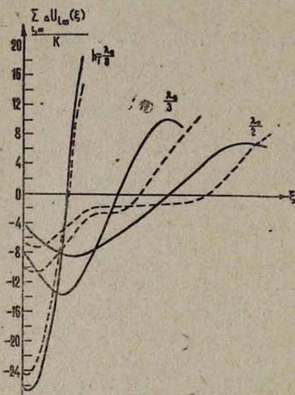
Рис. 1. Распределения частиц по энергии после выхода из резонатора длиной  $h = \frac{\lambda_0}{2}$  для сгустков различной длины с учетом первых 25 мод колебаний. Сплошные кривые — для случая  $\rho(x) = \frac{\pi}{2} \sin \frac{\pi v}{h_1} x$ , пунктир — для  $\rho(x) = 1$ ;  $\xi$  — момент влета частицы в резонатор,  $\lambda_0$  — длина волны на основной моде,  $K = \frac{Q}{\pi \epsilon_0 \lambda_0}$ . До входа в резонатор энергии частиц одинаковы.
