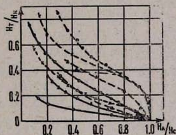
Рис. 2. Критические кривые сползания (сплошные) и переключения (пунктирные) для шероховатых пленок различной толщины: ○ — 31 (2,24 мкм); × — 34 (0,73 мкм); ▲ — 32 (1,47 мкм); ● — 35 (0,37 мкм).
