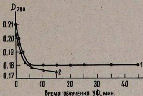
Рис. 2. Изменение оптической плотности полосы  $780 \text{ см}^{-1}$  со временем облучения УФ. Кривая 1—65% конв., 2—95% конв.
