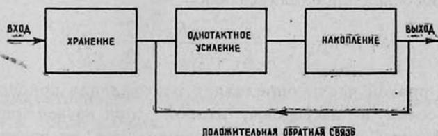
Рис. 2. Структура усилителей на магнитных материалах.
