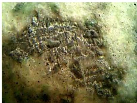
**Рис. 3** Коллоидно-зональные гидроокислы железа вокруг выщелоченных диатомовых водорослей. Аншлиф x400
