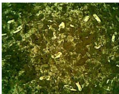
**Рис.6** Рассеянная вкрапленность псевдоморфоз гидроокислов железа по диатомовым водорослям. Аншлиф x210
