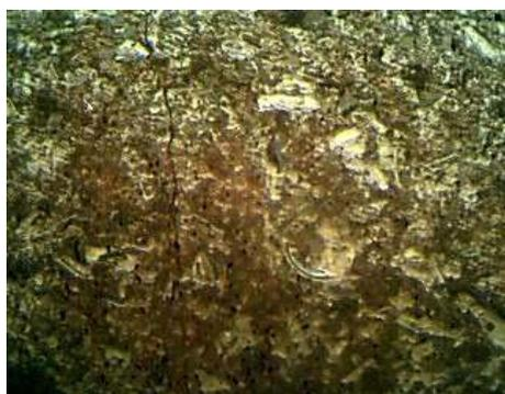
**Рис. 5** Вкрапленники и псевдоморфозы гидроокислов железа по диатомовым водорослям. Аншлиф x210
