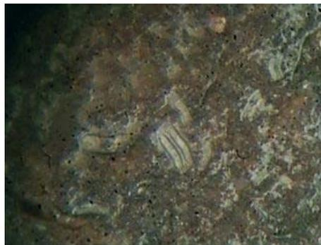
**Рис. 4** Вкрапленники и псевдоморфозы гидроокислов железа по диатомовым водорослям. Аншлиф x400
