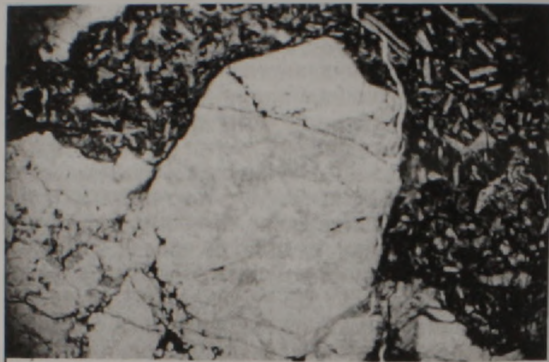
Рис. 6. Вращение призматического монокристалла кварца из рудной жилы в диабазовую дайку. Прозр. шлиф. Увел. 44. При одном николе.
