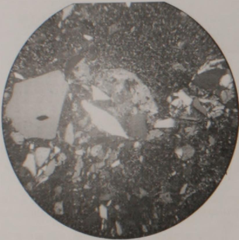
Рис 3 Кварцевый дацит. Прозрачный шлиф, ув 42х, николи скрещены. Заметно обилие угловатых осколков кварца, слева-слегка оплавленный кристалл кварца. Основная масса породы микрофельзитовая.
