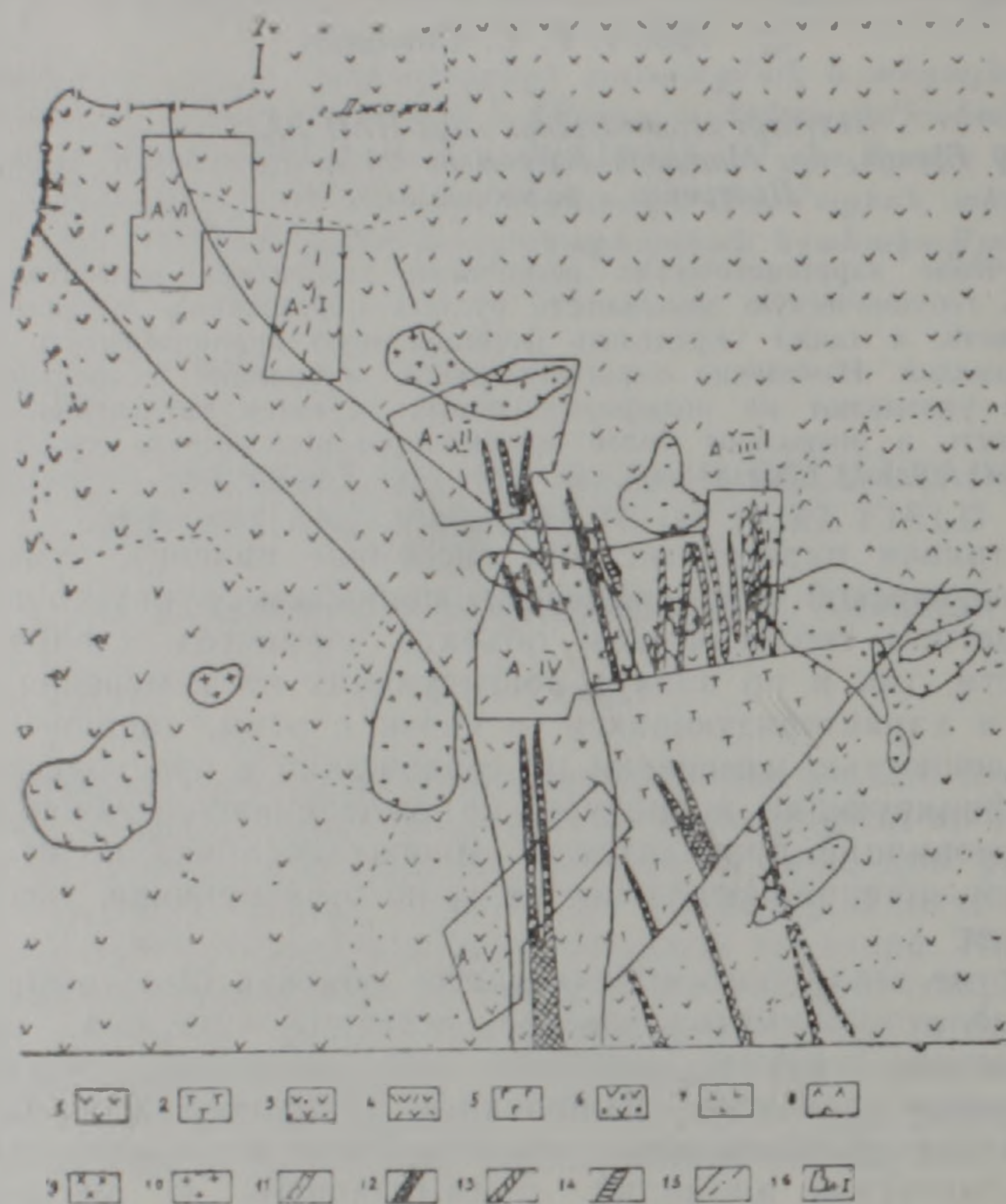
Рис. 1. Схематическая геологическая карта участка Мазмазак (Аревис) с контурами геохимических аномалий, М 1:10000. Геологическая основа по С. С. Даллакян. 1. Андезиты, андезито-дацитовые порфиры. 2. Туфопесчаники. 3. Туфобрекчии порфиров. 4. Андезитовые порфиры, гидротермально измененные. 5. Грейзенизированные породы. 6. Ороговикованные порфиры. 7. Экструзивные тела дацитов и андезито-дацитов. 8. Диориты, кварцевые диориты. 9. Кварцевые сениито-диориты. 10. Гранодиориты. 11. Дайки андезитового состава. 12. Кварц-порфировые дайки. 13. Диорит-порфировые дайки. 14. Дайки диабазового состава. 15. Тектонические нарушения. 16. Контуры геохимических аномалий.
