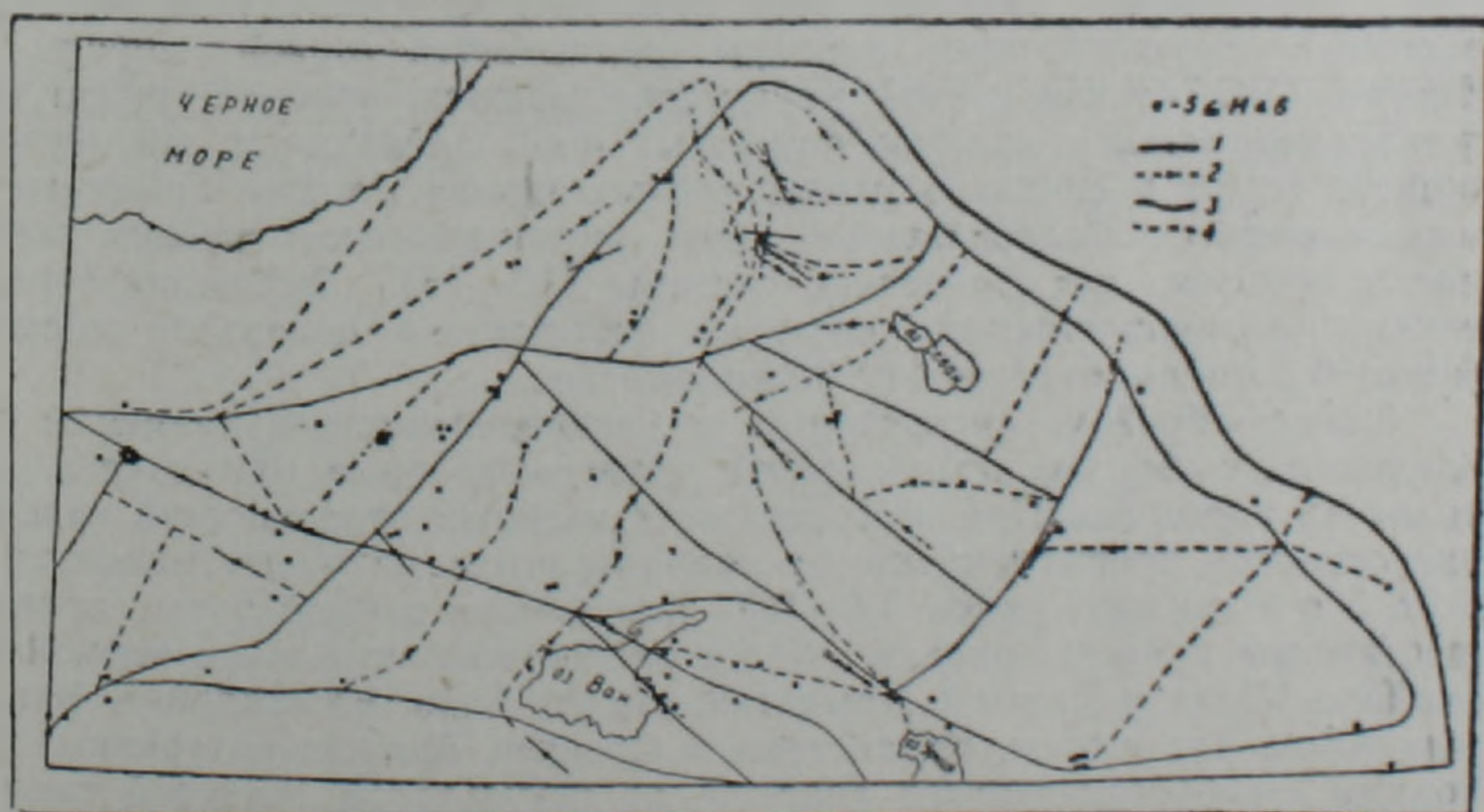
Рис. 2. Схема расположения блоков первого и второго порядков. Разрывы в очагах землетрясений: 1—по инструментальным данным; 2—по макросейсмическим данным. Границы блоков: 3—первого порядка, 4—второго порядка.
