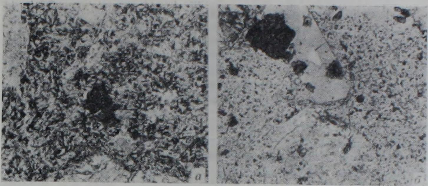
Рис. 3. Пироксен-плагноклазовые андезиты шихтактского комплекса (без анализатора). а) Фенокристалл магнетита (черное) и мелкий (менее 0,01 мм) магнетит в основной массе, близкой к интерсертальной; б) Сросток фенокристаллов магнетита (черное) и пироксена (серое) и мелкий магнетит в аморфной основной массе. Количество мелкого ферромагнетика заметно меньше, чем в первом случае. Ув. 57X.
