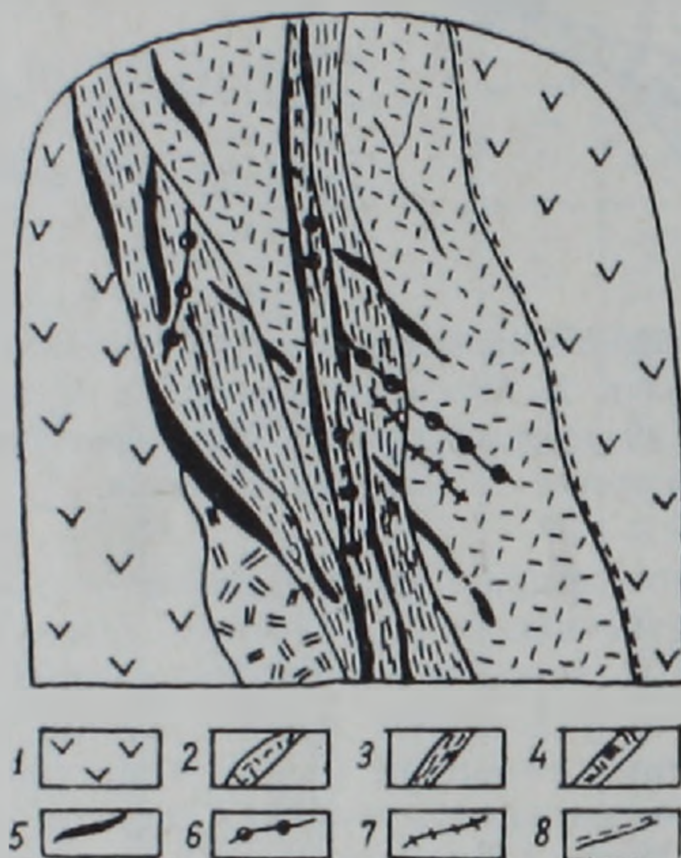
Рис. 4. Соотношение минетты с жилой № 1 (шт. 73, штр. 9 инт. 110 м.). 1. Андезиты. 2. Измененная минетта. 3. Кварцевая безрудная жила. 4. Брекзиты. 5. Полиметаллические прожилки. 6. Пиритовые прожилки. 7. Прожилки карбоната. 8. Глинка трения.
