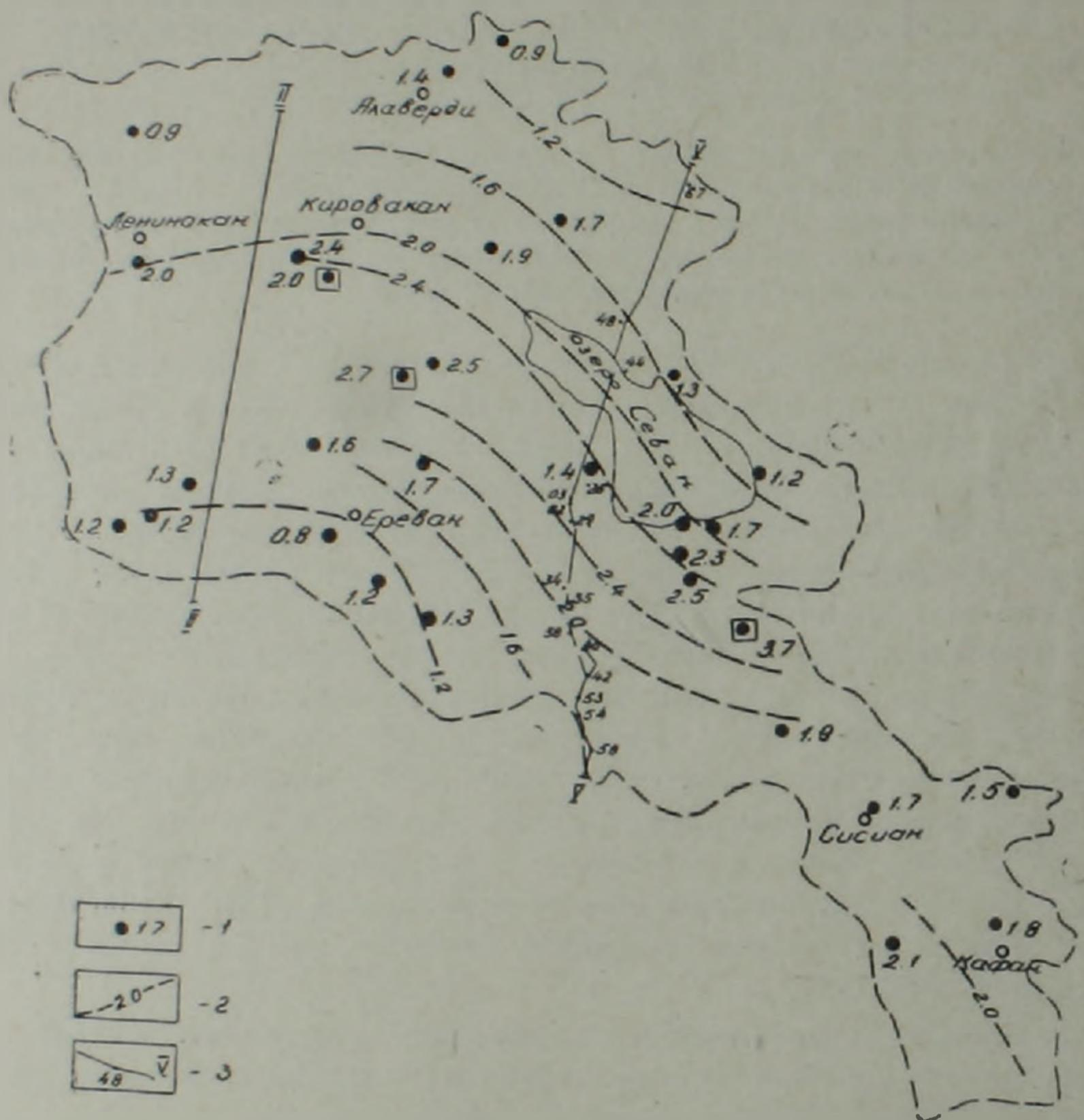
Рис. 1. Карта тепловых потоков Армянской ССР. 1. Пункты определения теплового потока. Значение в  $\text{мккал}/\text{см}^2\text{сек}$ . (Данные Р. Т. Мириджяна и А. А. Аветисянца). 2. Изолинии теплового потока. 3. Профиль МТЗ с пунктами наблюдения.
