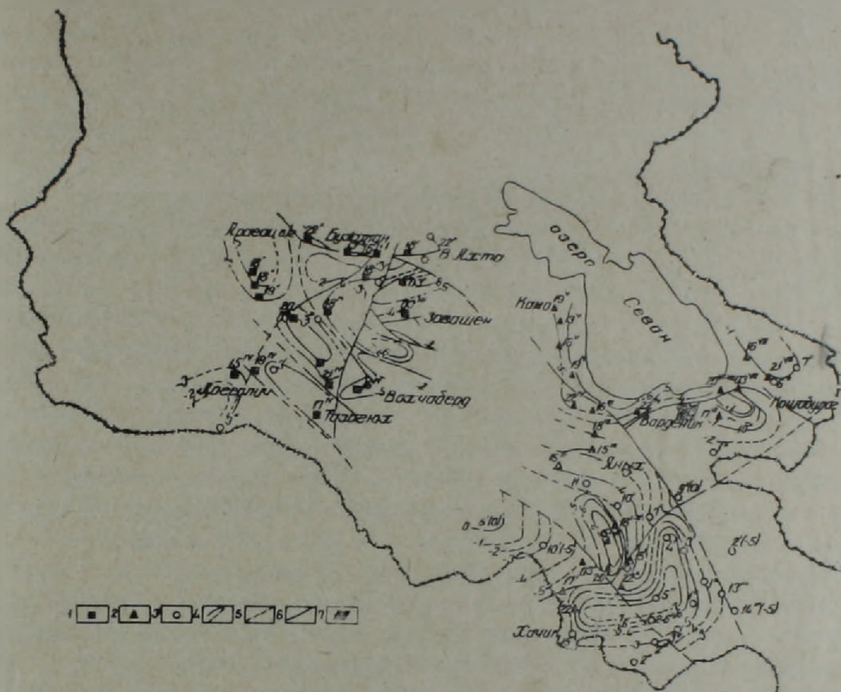
Рис. 4. Схема строения поверхности фундамента районов работ 1975—76 гг. 1. Пункты наблюдений со станциями «Черепаша» в 1975 г. 2. Пункты наблюдений со станциями «Черепаша» в 1976 г. 3. Пункты наблюдений со станциями «Земля». 4. Изолинии поверхности фундамента. 5. Линии предполагаемых тектонических нарушений. 6. Линии тектонических нарушений. 7. Зоны отсутствия обменов.
