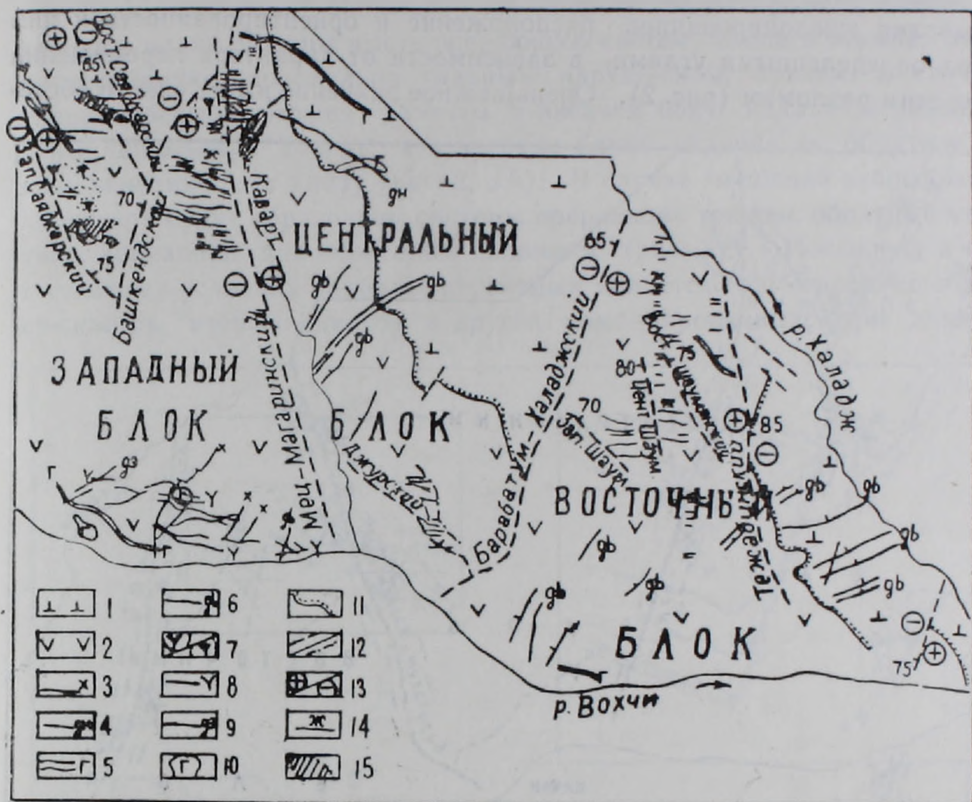
Рис. 1. Структурная схема расположения рудных тел, дайковых и субвулканических образований в различных блоках Кафанского рудного поля. 1. Верхнеюрские вулканические образования. 2. Среднеюрские вулканические образования. Дайки неокомского возраста. 3. Диорит-порфиры. 4. Диабазы. 5. Габбро-диабазы: а) на поверхности, б) в подземных выработках. 6. Верхнеюрские диабазы и диабазовые порфиры: а) на поверхности, б) в подземных выработках. Среднеюрские образования. 7. Тела дацитовых порфиров: а) на поверхности, б) в подземных выработках. 8. Дайки андезитов. 9. Дайки эпидотизированных диабазов. 10. Габбро. 11. Контакты несогласно залегающих тел. 12. Тектонические нарушения: а) на поверхности, б) в подземных выработках. 13. Направления перемещения блоков: а) вверх, б) вниз. 14. Рудные жилы. 15. Штокверки.
