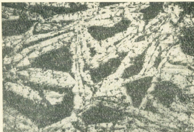
Рис. 3. Решетчатая структура мушкетовитовой руды. Мушкетовит (светло-серое), нерудная масса (темно-серое). Месторождение Цакери-дош. Полиров. шлиф, ув. 70 \times .
