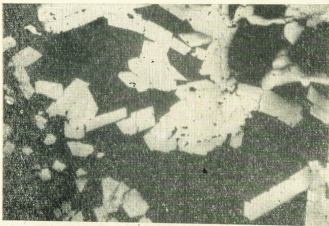
Рис. 4. Мушкетовитовая руда. Мушкетовит (светло-серое), нерудная масса (темно-серое). Месторождение Мисхана. Полиров. шлиф, ув. 70 \times .
