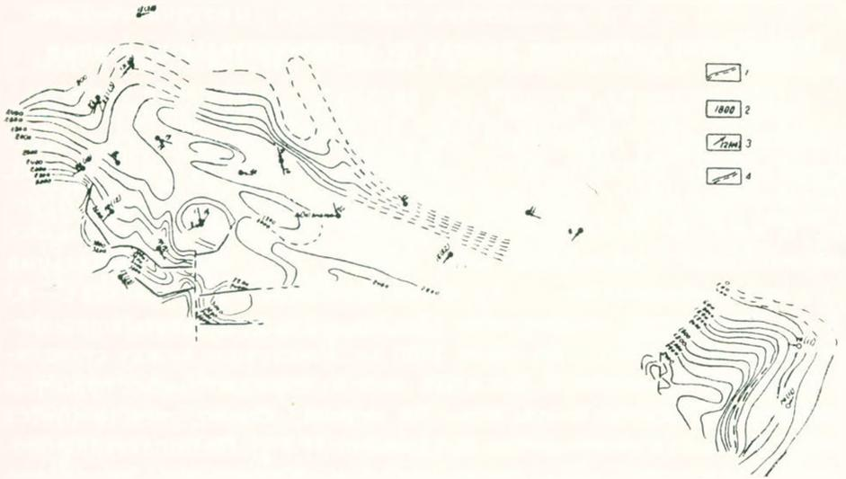
Фиг. 5. Схема рельефа поверхности фундамента (по данным Л. М. Найдиса и А. И. Авакяна, 1970 г.). 1—изогинсы поверхности фундамента по данным КМПВ; 2—абсолютные отметки фундамента; 3—направление восстания и угол наклона поверхности фундамента, определенные по данным о поляризации волн; цифра в скобках—наклон фундамента по данным КМПВ, 4—линии нарушения, трассируемые и предполагаемые.
