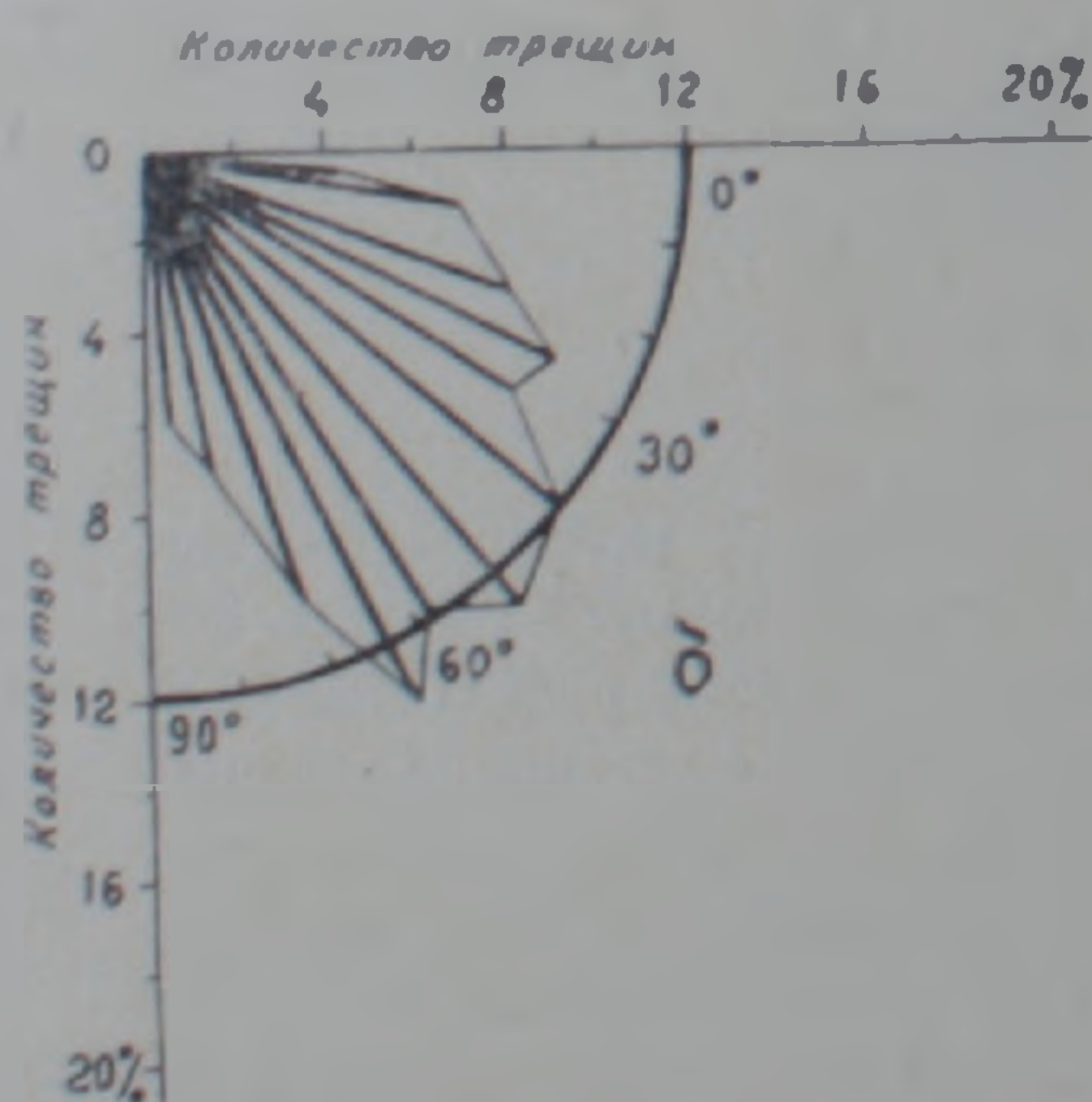
Фиг. 2. Розы-диаграммы количества трещин разной крутизны: а—в андезитовых и дацитовых порфиритах; б—в лапиллиевых и гравийных туфах и туфовых брекчиях андезито-дацитовых порфириров; в—в кератофирах, кварцевых кератофирах и кварцевых порфирах; г—в полимиктовых и туфогенных песчаниках; д—в альбитофирах и кварцевых диоритах.
