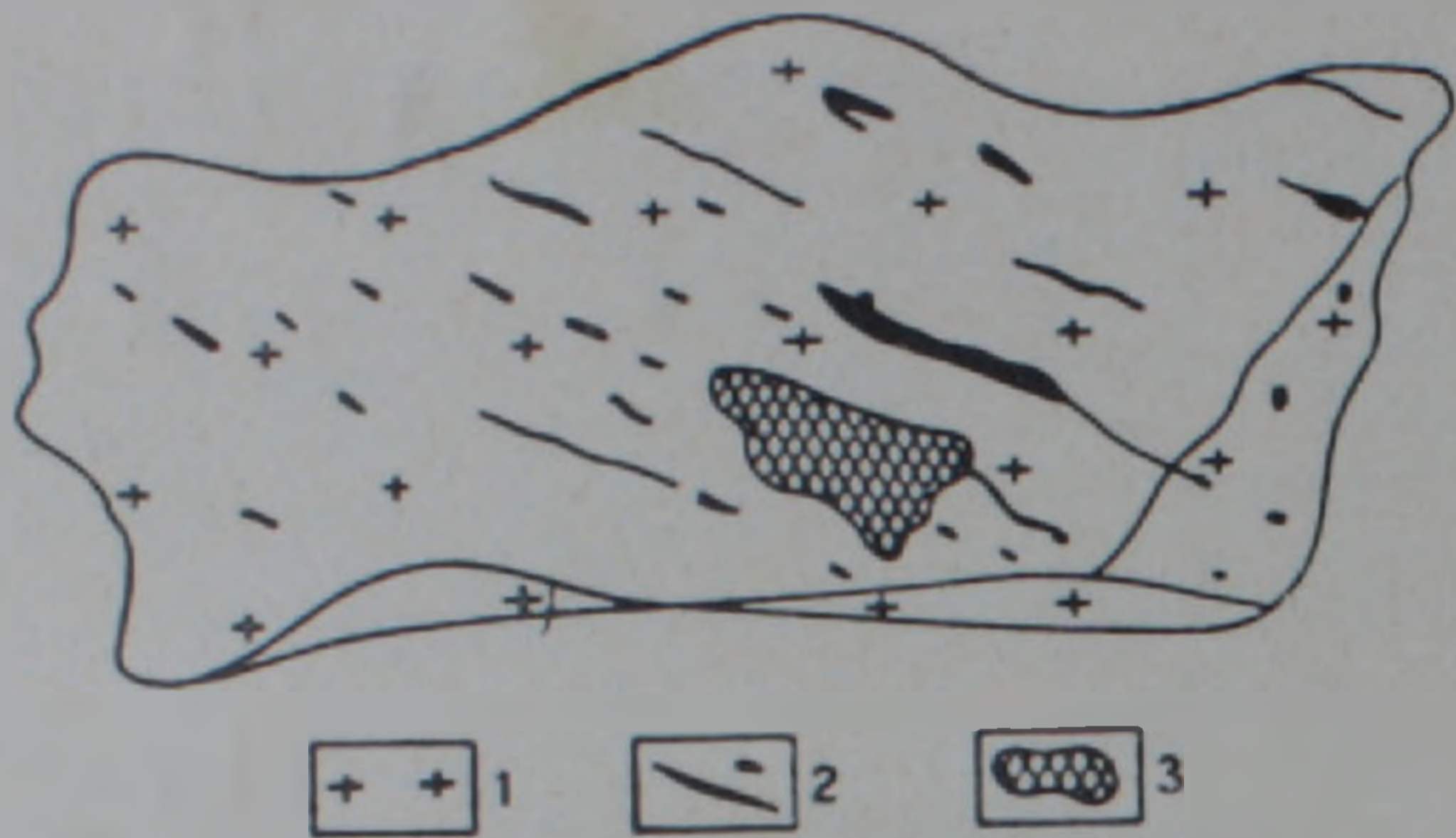
Фиг. 7. Зарисовка образца оруденелой кварц-порфировой дайки с рудным ксенолитом. 1. Гидротермально-переработанная дайка кварцевых порфиров. 2. Сульфидные прожилки, вытянутые по линиям течения дайки. 3. Рудный «ксенолит» с сульфидной минерализацией и с тонкой гарниеритовой (?) оторочкой.
