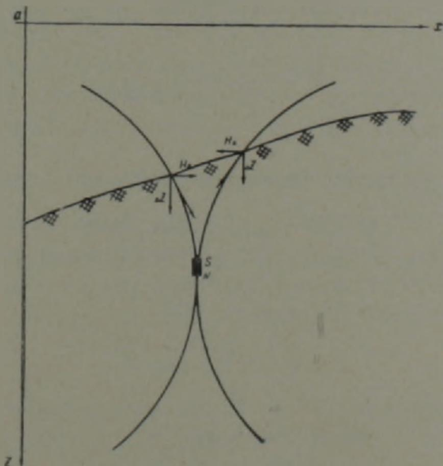
Фиг. 1. Схема магнитного поля от элементарной магнитной массы в плоскости  $XOZ$ .
