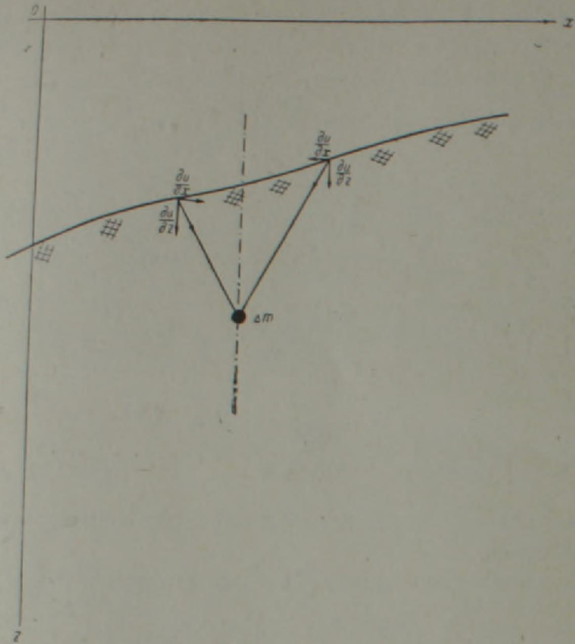
Фиг. 2. Схема гравитационного поля от элементарной массы  $\Delta m$  в плоскости  $XOZ$ .
