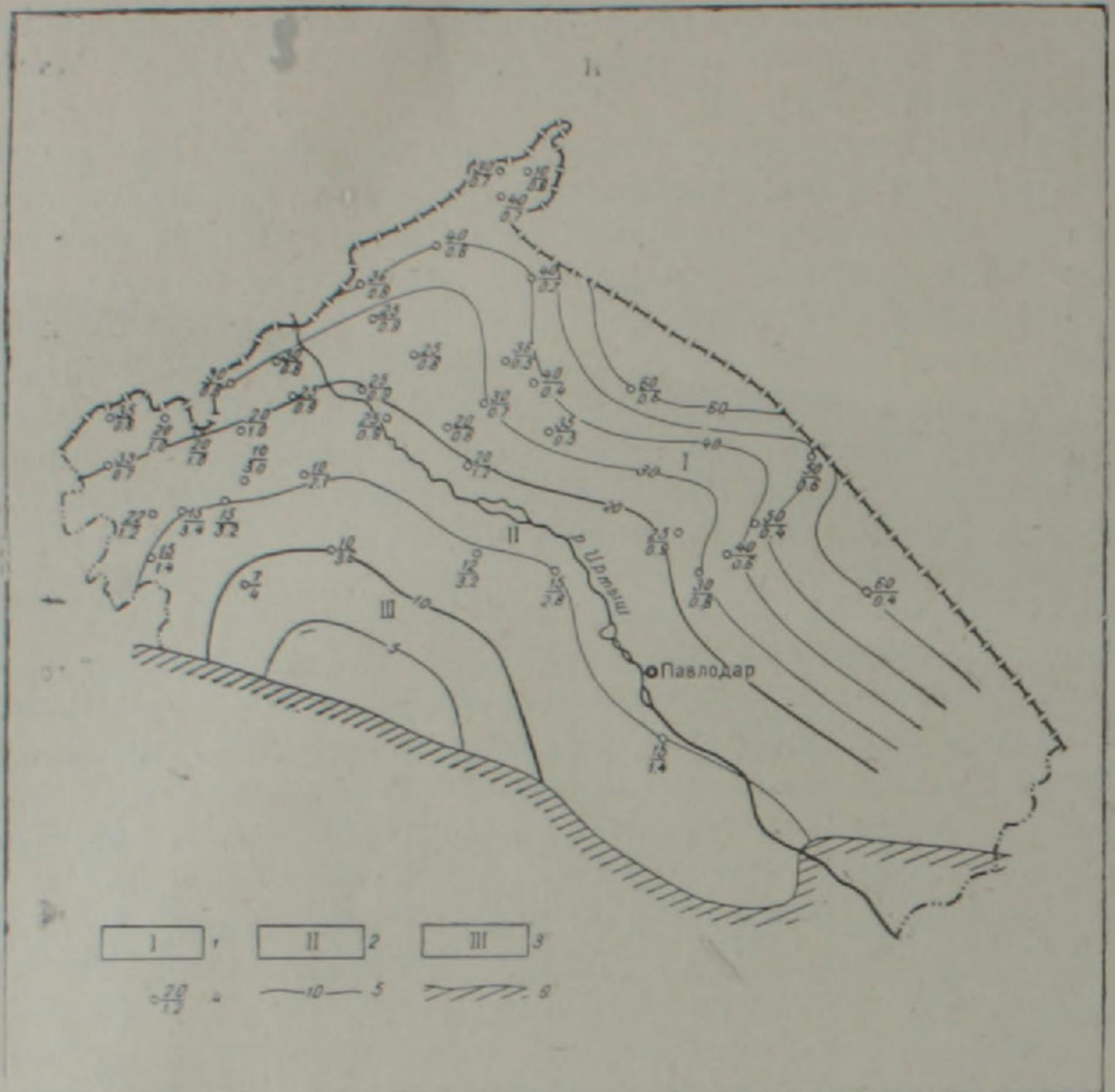
Фиг. 1. Карта общей минерализации покурского водоносного горизонта по данным каротажа 1. I зона пресных вод с минерализацией до 1 г/л (60—20 омм). 2. II зона слабосоленоватых вод с минерализацией от 1 до 3-х г/л (20—10 омм). 3. III зона сильносоленоватых вод свыше 3-х г/л. 4. Числитель—значение кажущихся удельных сопротивлений в омм. Знаменатель—значение общей минерализации по каротажу.
