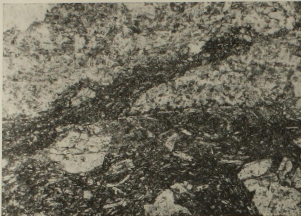
Фиг. 4. Апофиза дайки (темное), проникающая в экранирующие ее туффиты (светлое вверху). Прозр. шлиф. Увелич. 26. При одном никеле.
