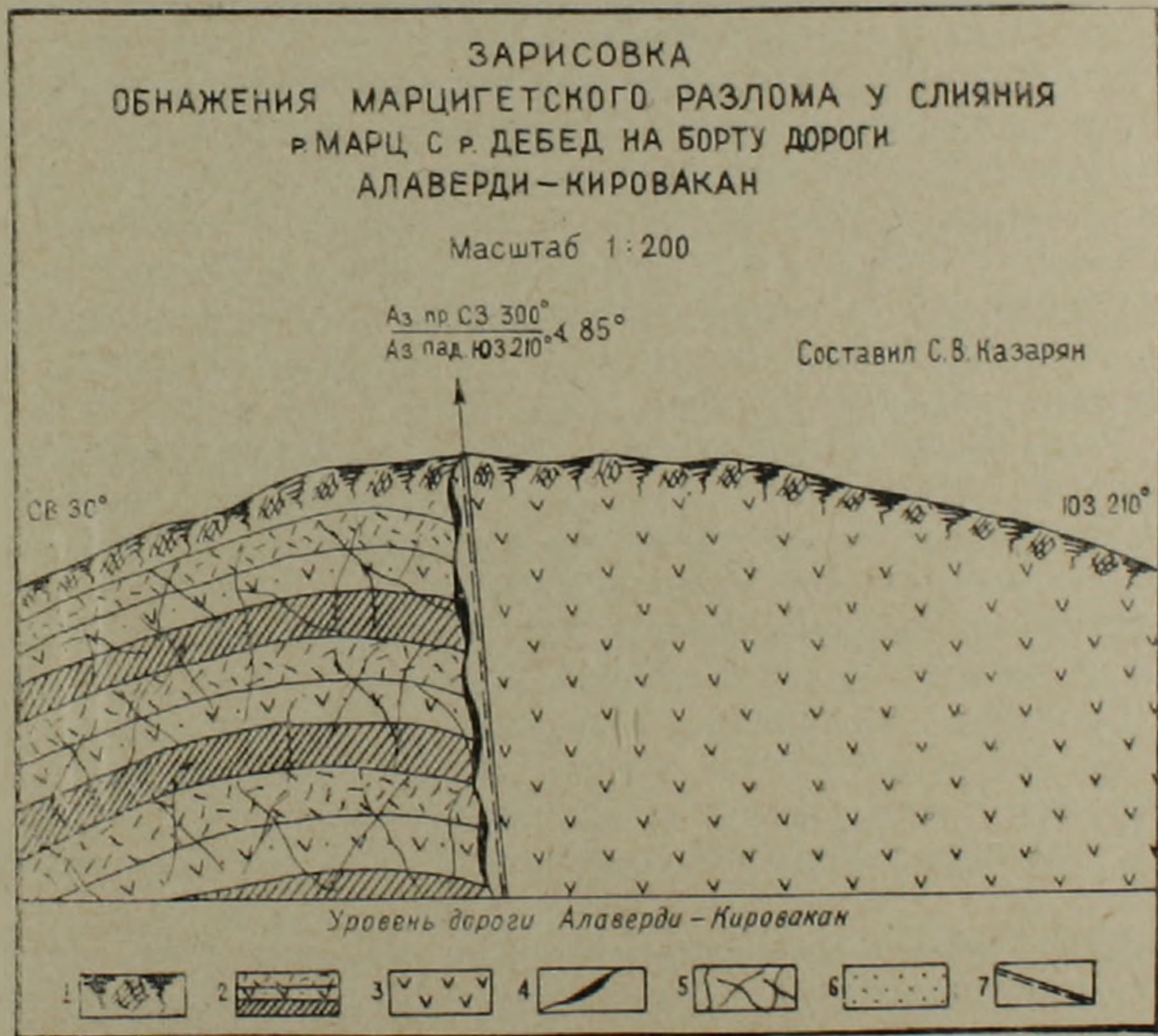
Фиг. 3. Почвенно-растительный слой. 2. Вулканогенно-осадочные, гидротермально-измененные, огнеупорные и тугоплавкие породы—порфиры, туфопесчаники, туфы. 3. Дацитовые порфиры. 4. Тектоническая глина. 5. Раздробленность пород. 6. гидротермальное изменение. 7. Марцигетский разлом.
