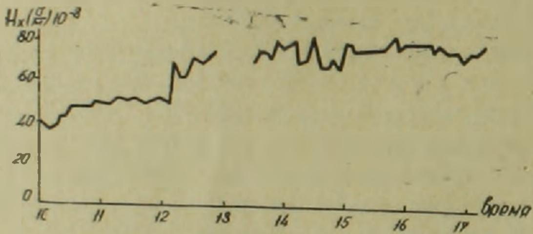
Фиг. 2. Кривая изменения напряженности поля  $H_x$  во времени при наблюдениях на земной поверхности (участок Ахтала).
