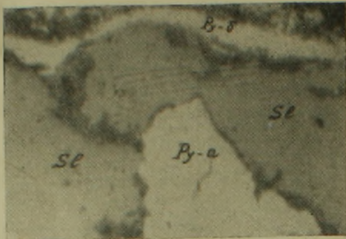
Фиг. 8. Крупнозернистый агрегат раннего пирита (Py-a) в сфалерите (Sl). Последний по краям окаймляется более поздними тонкозернистыми массами пирита (Py-b). Месторождение Каялу. \times 100 .
