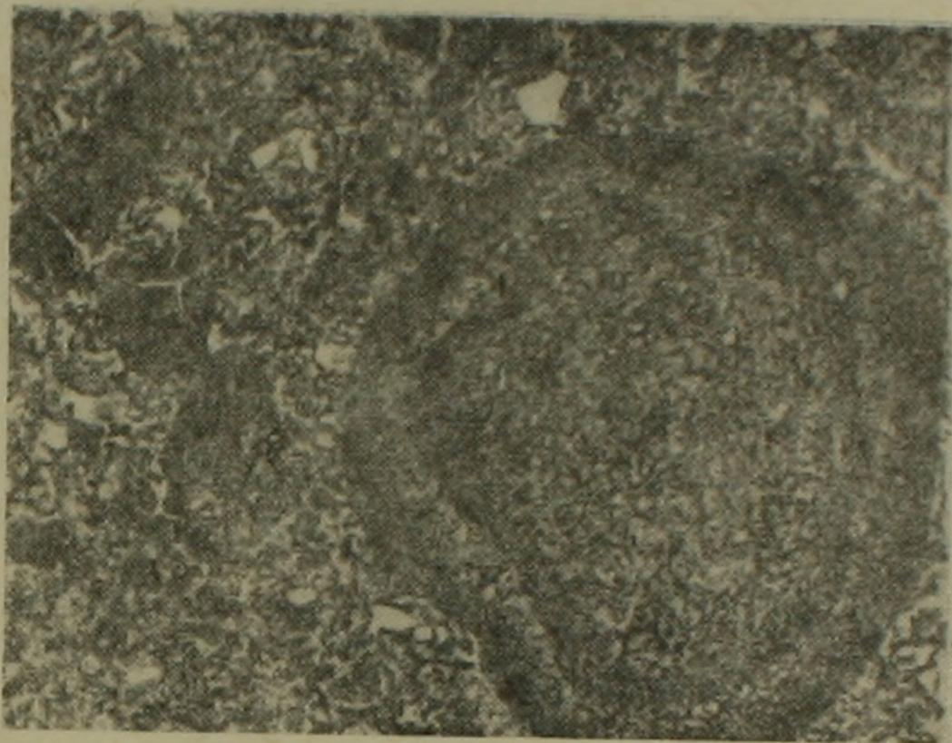
Фиг. 3. Пизолитовый туффит. Концентрически-зональное строение пизолита. Прозрачный шлиф. Без анализатора.  $\times 20$ .
