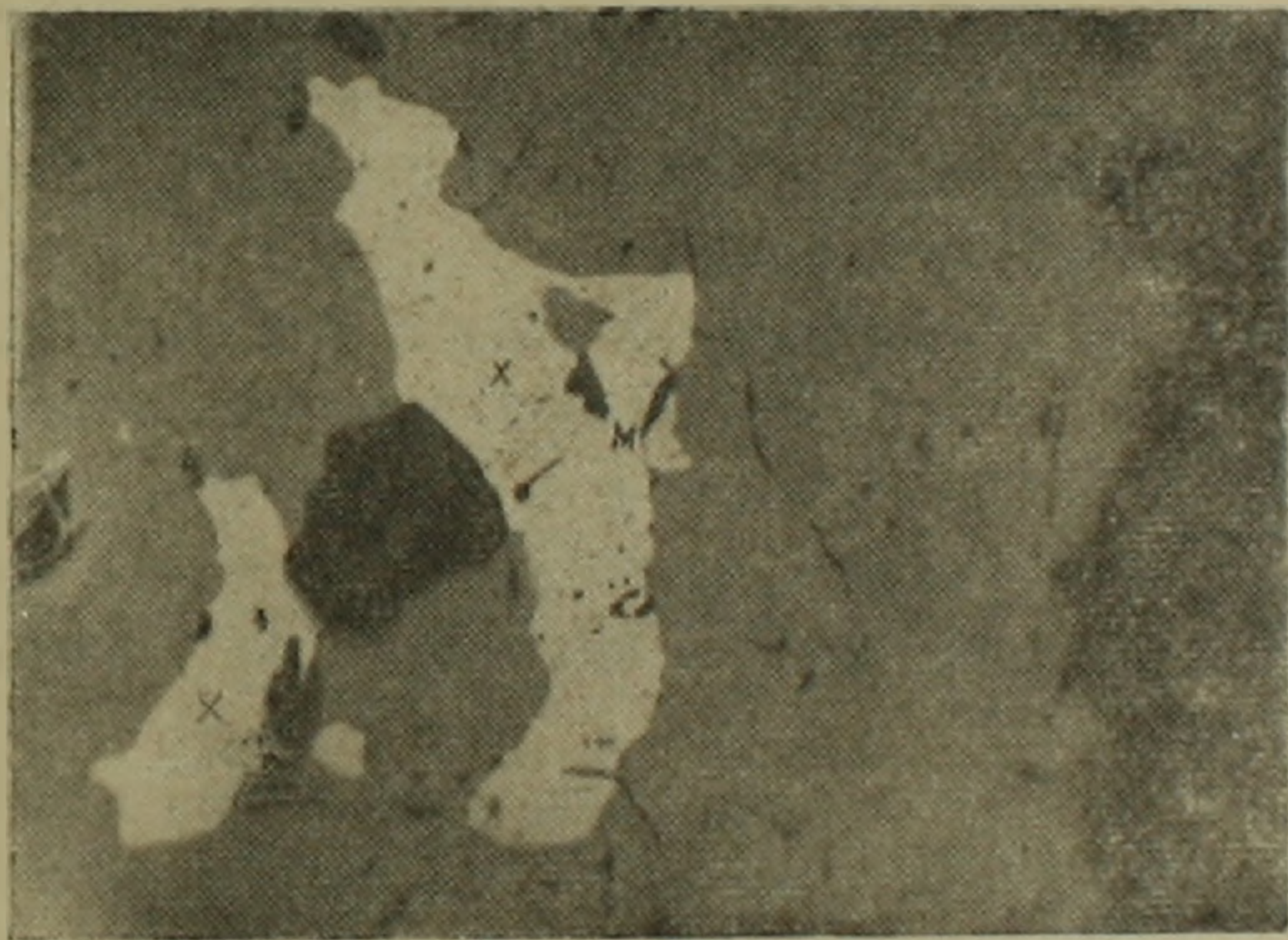
Фиг. 1. Пластинчатое выделение миллерита (М) в полях халькопирита (Х). Серое поле— теннантит.
