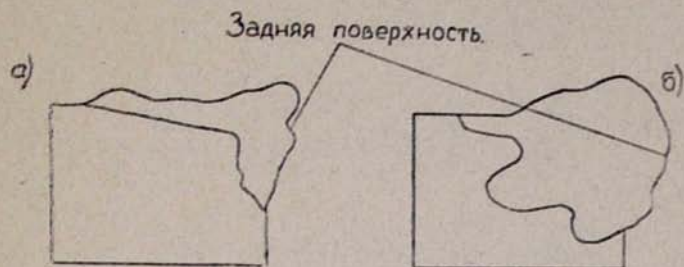
Рис. 1. Пластически деформированные пластины кермета NC20M: а) v = 78 м/мин; s = 0,15 мм/об; t = 1 мм; б) v = 80 м/мин; s = 0,15 мм/об, t = 0,5 мм.
