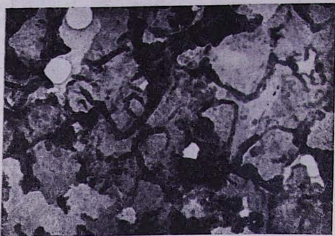
Рис. 13. Структура сплава Ti5K6. Увел. 6000 после бомбардировки
