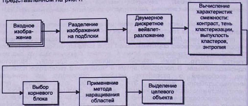
Рис.1. Схема выделения целевого объекта из изображения
