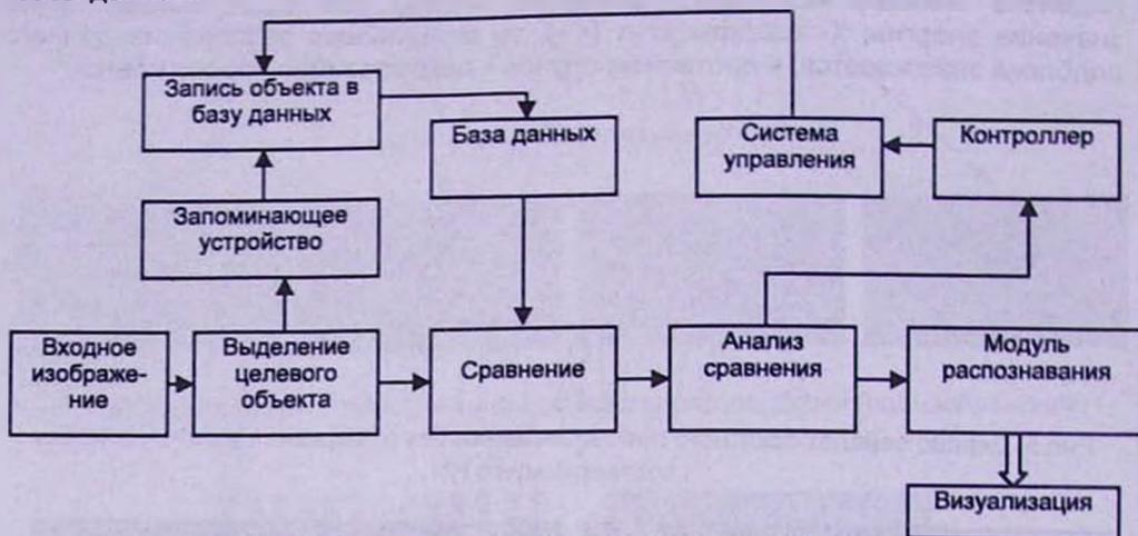
Рис 7. Структура системы распознавания объектов
