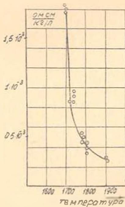
Рис. 2. Зависимость удельного электрического сопротивления жидкого карбида кальция, отнесенная к плотности.
