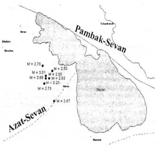
Рис. 2. Азат – Севанский разлом и эпицентры слабых землетрясений инструментального периода (Э. Харазян, 2005).
